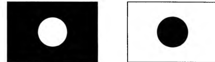
Рис. 5. Схематичне зображення локального катоду (темна - область катоду покрита хімічно стійким лаком, світла - область катоду доступна для осадження): а) S = 0,785 \cdot 10^{-4} м 2 ; б) S = 2,455 \cdot 10^{-4} м 2 , де S - доступна для осадження площа катода.
